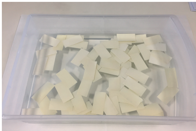
Fig. 2. Probetas con barniz de colofonia y dammar a distinta concentración en una cubeta con agua durante la realización del ensayo de resistencia a la inmersión en agua
